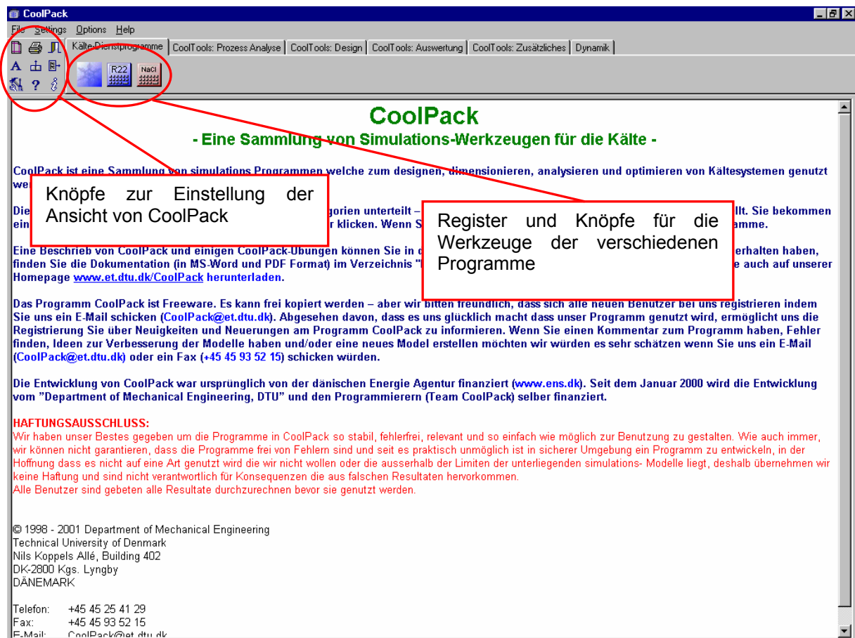
Abbild 5.1: Hauptschirm in CoolPack
